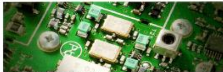
標準装備の3kHz/15kHzルーフィングフィルタ
